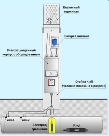
**ПКМ-ТСТ-КонтКорр** - комплексная подсистема контроля и анализа коррозионной ситуации на подземных стальных трубопроводах.
